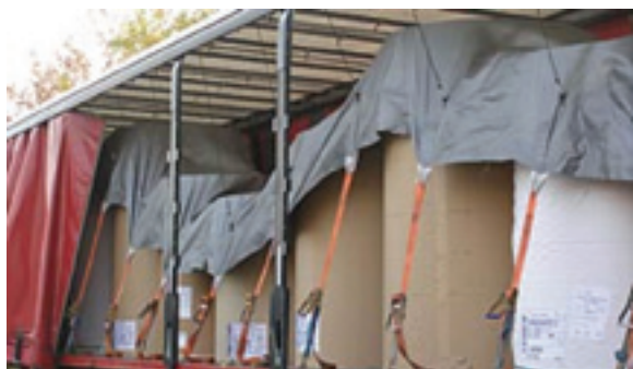
Obr. 31: Zabezpečenie pomocou prikrývky
