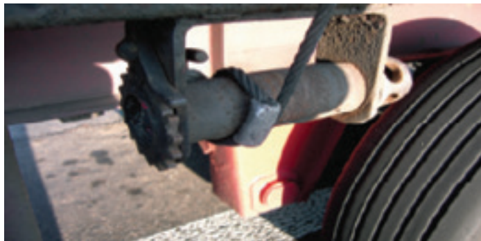
Obr. 24: Oceľové lano napínané navijakom
