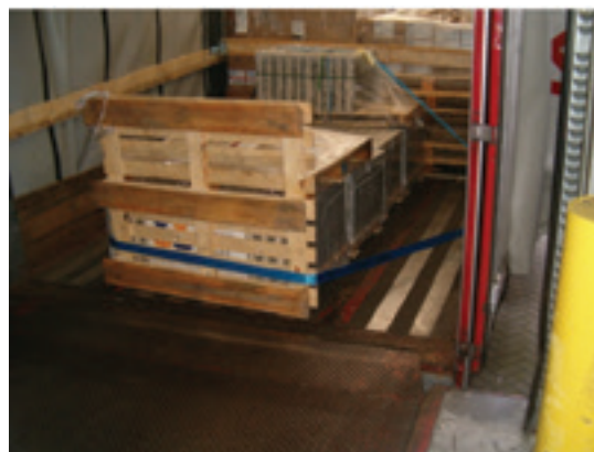
Obr. 75: Pripevnenie zmiešaného nákladu odzad
