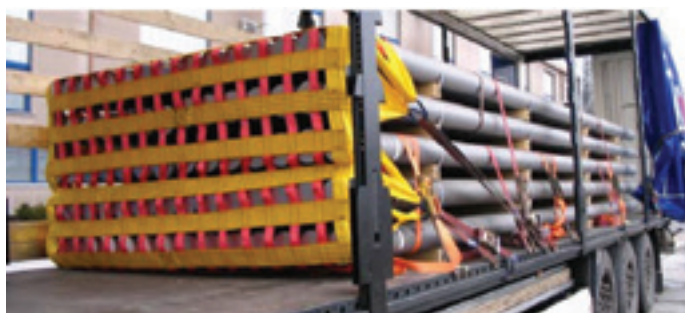
Obr. 32: Zabezpečenie pomocou siete a priameho priviazania smerom dopredu
