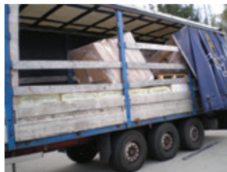
Obr. 19: Nedostatočné zabezpečenie nákladu iba pružnou obalovou fóliou
