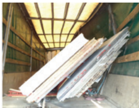
Obr. 45: Zosunutá konštrukcia v tvare písmena A
