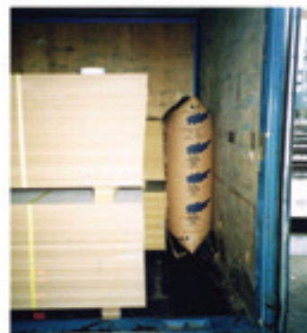
Obr. 29: Vzduchový vankúš na bočné blokovanie
